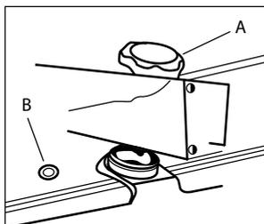
А. Крышка топливного бака
